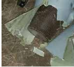
Les différentes épaves de drones azéris Harop présentent une charge à billes, antipersonnelles
